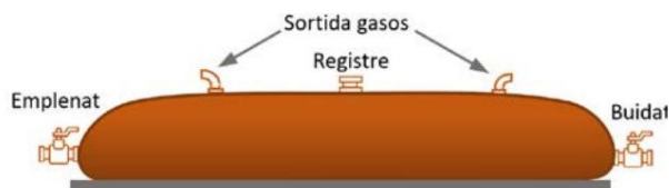
Figura 4. Conexiones de la bolsa flexible de purines.
